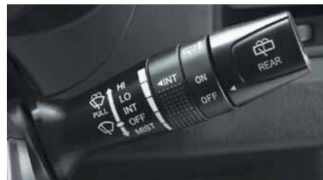
Prekidač na desnoj strani sa kontrolom brisača vjetrobranskog stakla
