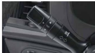
Prekidač na lijevoj strani za upravljanje smjera vožnje i kontrolama putnog računara
