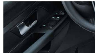
Upravljanje električnim prozorima i vanjskim ogledalima na vratima vozača
