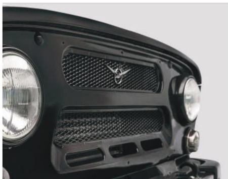
Metalna rešetka s finom mrežom štiti radijator od agresivnog okoliša
