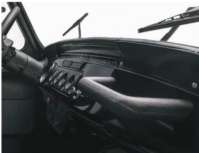
Ručka za jednostavno ulaženje i izlaženje sa prednje strane kabine
