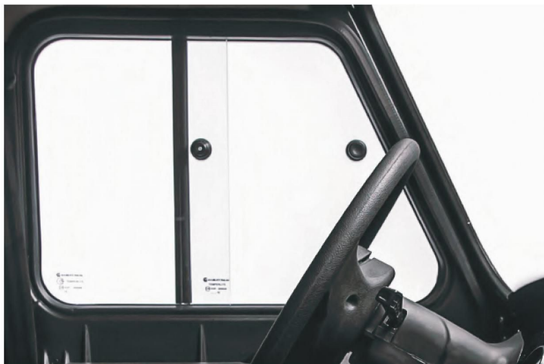
Pouzdan mehanizam za otvaranje i zaključavanje prozora
